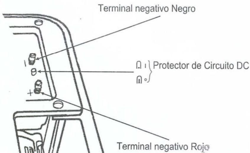
El protector de fusible DC se salta automáticamente cuando el circuito es sobrecargado, cuando hay un problema con la batería o las conexiones entre la batería y el generador son incorrectas.
